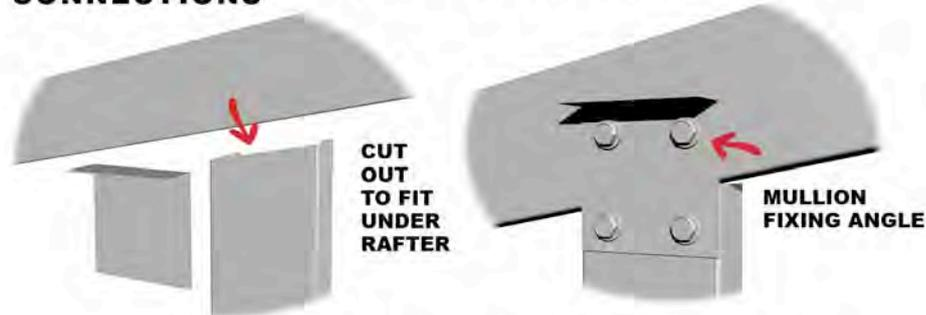
**GABLE END WALL ROLLER DOOR JAMB TO RAFTER CONNECTION**
